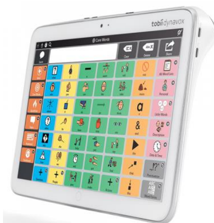
Obr. 24 Zařízení s hlasovým výstupem – dynamická obrazovka (Indi od společnosti Tobii-Dynavox) Zdroj: LinkAssistive, 2018
