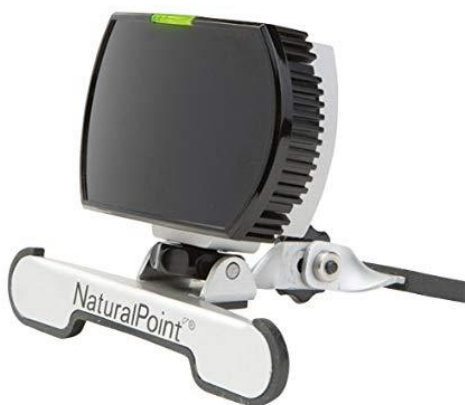
Obr. 38 Snímač pohybu hlavy (reflexního bodu) – SmartNAV 4: EG Zdroj: Natural Point, 2018
