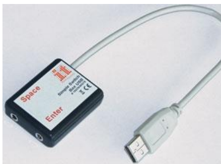
Obr. 45 Adaptér Simple Box Switch – nelze již dále programovat Zdroj: Assistive Technology – DTSL
