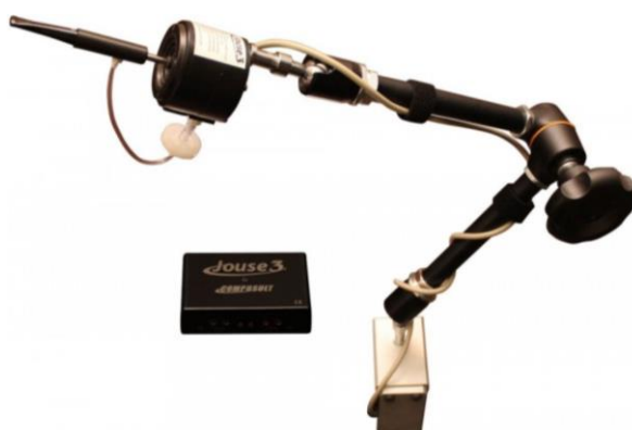
Obr. 35 Speciálně upravený joystick pro ovládání za pomoci orofaciální části Zdroj: School Health, 2018
