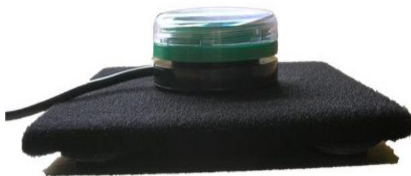
Obr. 49 Plochá podložka pro ovládání tlačítkového komunikátoru, spínače apod. Zdroj: Medical Engineering Resource Uni, 2018
