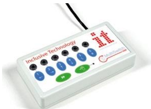
Obr. 47 Adaptér Inclusive MultiSwitch 2 s možností připojit a naprogramovat až 6 spínačů Zdroj: Assistive Technology – DTSL
